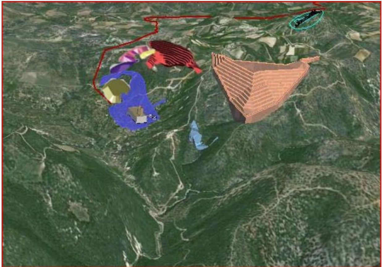
Σχήμα 3. Μοντέλο της „βαθμιδώδους πυραμίδας“ μεταλλευτικών τελμάτων, ανυψωμένη πάνω από το ρέμα Σπαλιτζάκ, το οποίο εκρέει στο κεντρικό ρέμα Παλιόρεμα. Αριστερά της „πυραμίδας“ παρουσιάζονται οι υπόλοιπες εγκαταστάσεις του προγραμματιζόμενου μεταλλείου (εικόνα ΠΠΕ της εταιρείας).
